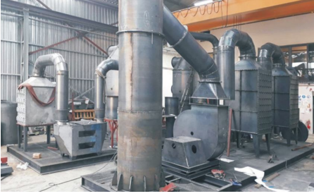
Asidik ve Bazik özellikli scrubber sistemleri ve ekonomizer sistemlerinin üretimi.
