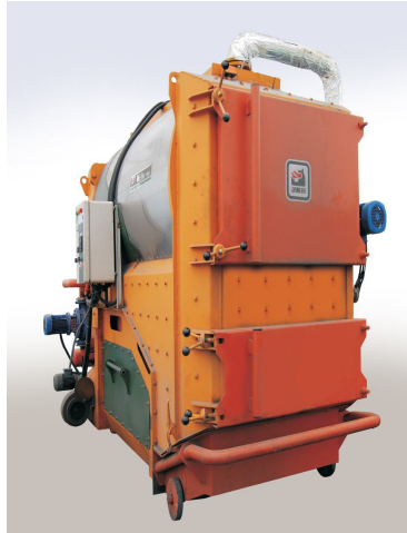
0-50 mm kömür yakmalı 500 Bin Kalori / Saat kapasiteli kazanlar
