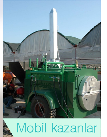
0-50 mm kömür yakmalı 500 Bin Kalori / Saat kapasiteli kazanlar
