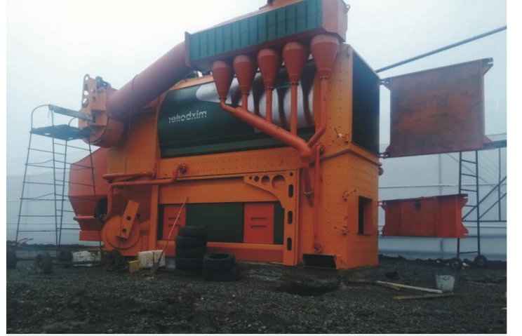
0-50 mm kömür yakmalı 3 Milyon Kalori / Saat kapasiteli kazanlar
