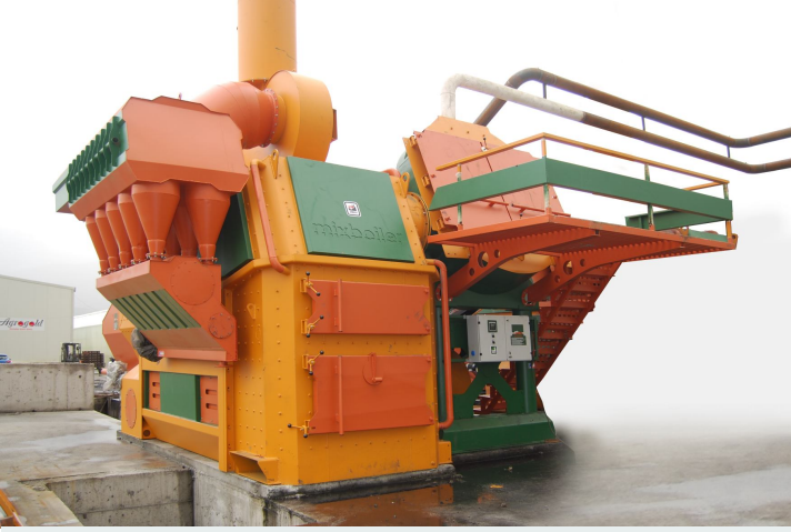
0-50 mm kömür yakmalı 6 Milyon Kalori / Saat kapasiteli kazanlar
